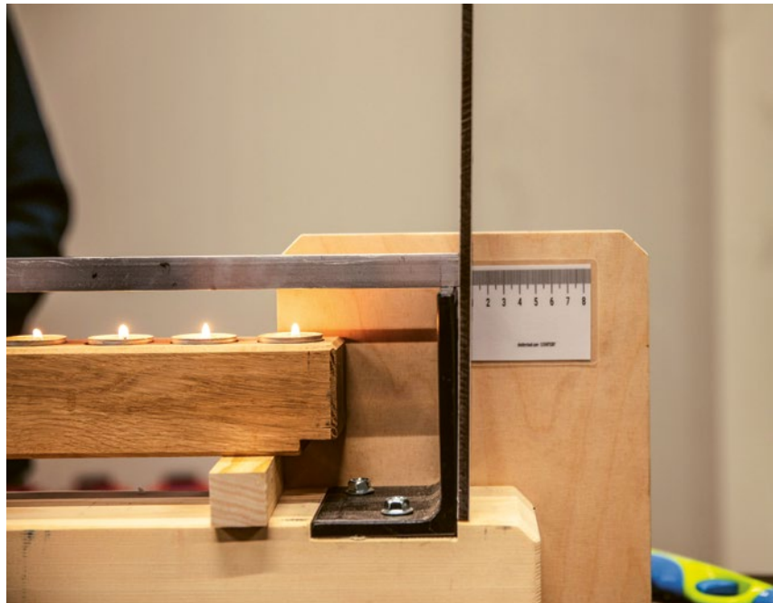
Am GVZ-Kurs «Brandschutzeinrichtungen im Einsatz» wird die Ausdehnung von Metalltragwerken im Brandfall und die Auswirkungen auf Wände demonstriert
